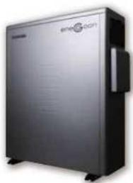
世界中のインフラで採用された高い「安全性」と、10,000回の充放電後でも約90%の容量を維持できる「長寿命」、 $-20^{\circ}\text{C}$ の環境でも約80%の容量を維持できる「低温での強さ」を発揮する蓄電池です。
