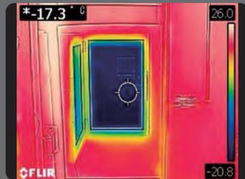
外気温が $[-20^{\circ}\text{C}]$ の時の受取扉（屋内側）の結露／断熱性能を試験で確認。寒冷地での壁埋込にも対応しました！
